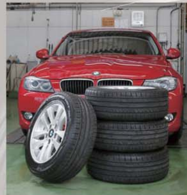
左右非対称の模様を持つチャンピロHPV。ミゾの面積が広い内側は効率的な排水性能を発揮し、外側のアウターブロックは理想的な路面コンタクトにより高いグリップ性能を発揮する。
