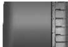
ブロックの動きを抑えて片ベリ編摩耗しにくいアウターショルダーになっている。
